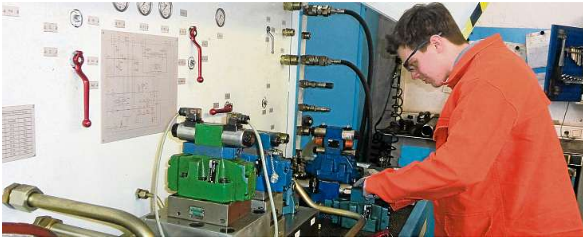
Der Fachoberschüler Alexander Schwarz arbeitet am Hydraulikprüfstand. Er ist mit der Montage eines Ventils und Prüfarbeiten beschäftigt in den Werkstätten Mechanik der Abteilung Instandhaltung des Stahlwerks Thüringen GmbH. Foto: Dieter Fuchs
